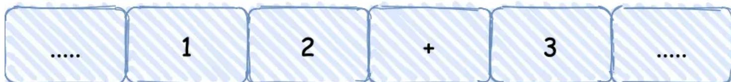
通过上面的图灵机计算  $1 + 2$  的过程，可以发现图灵机主要功能就是读取纸带格子中的内容，然后交给控制单元识别字符是数字还是运算符指令，如果是数字则存入到图灵机状态中，如果是运算符，则通知运算符单元读取状态中的数值进行计算，计算结果最终返回给读写头，读写头把结果写入到纸带的格子中。
